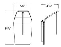
Model:WS72LEDWS72Lamping:12V LED Socket Set12V Halogen Socket SetPower:6.4W50W max
