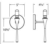
Model: WS57LED **Lamping:** Integral LED Power: 6W 305 Lumens:
